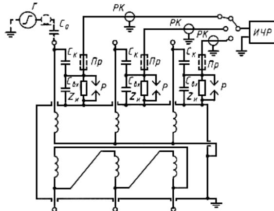
ИЧР - измерительный прибор (или комплект измерительных приборов);  $Z_k$  - сопротивление измерительного элемента; РК - измерительный кабель;  $C_k$  - емкость ввода или отдельного соединительного конденсатора;  $C_{вх}$  - емкость на входе измерительного устройства (суммарная
