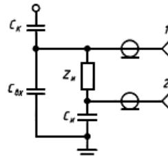
$C_k$  - емкость ввода или соединительного конденсатора;  $C_{ex}$  - емкость на входе измерительного устройства (суммарная емкость измерительной обкладки ввода и измерительного кабеля);  $Z_x$  - сопротивление измерительного элемента;  $C_u$  - емкость измерительного конденсатора; 1 - разъем для присоединения устройства измерений характеристик частичных разрядов; 2 - разъем для присоединения приборов, измеряющих испытательное напряжение
